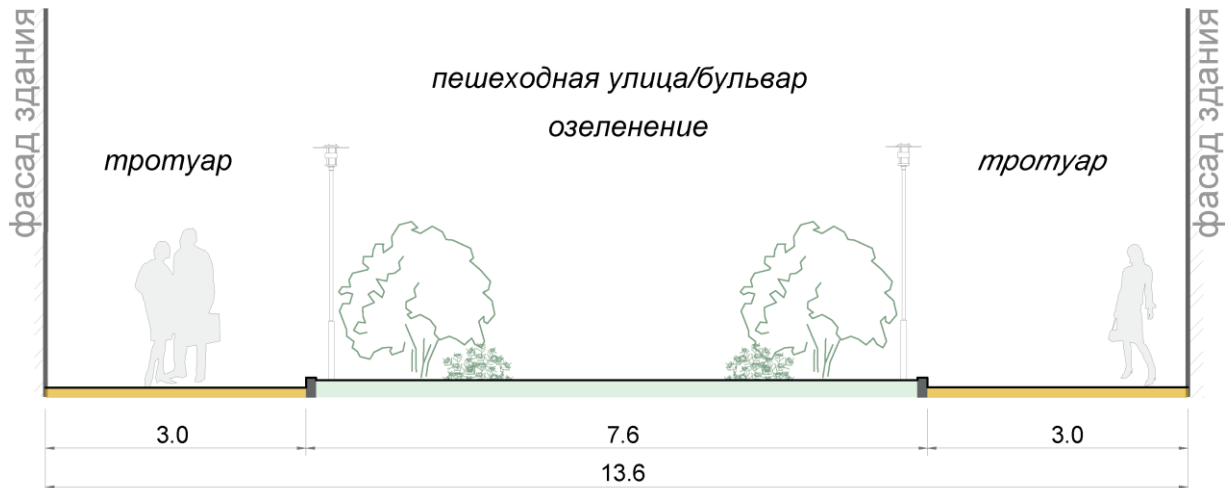
Рисунок 3 – Поперечный профиль планируемой пешеходной улицы/бульвара 2
