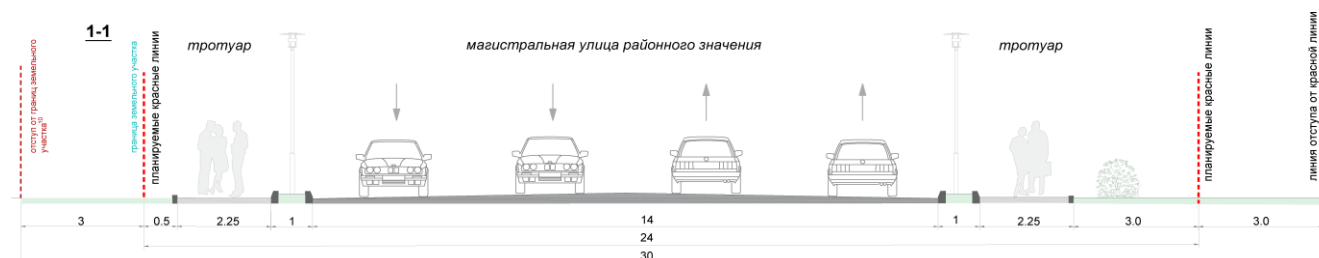
Рисунок 7 – Поперечный профиль а/д «Калиновка-Сапроново»
